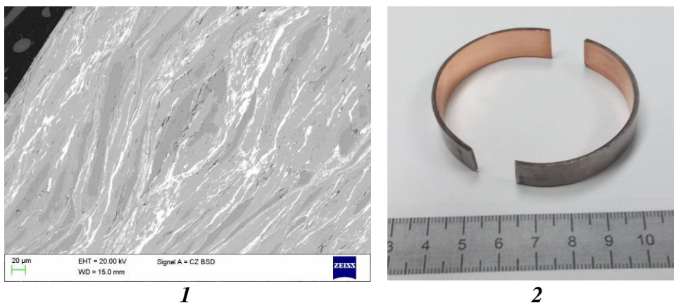
Рис. 59. Микроструктура композитного слоя (1); опытные образцы вкладыша подшипника скольжения (2).
