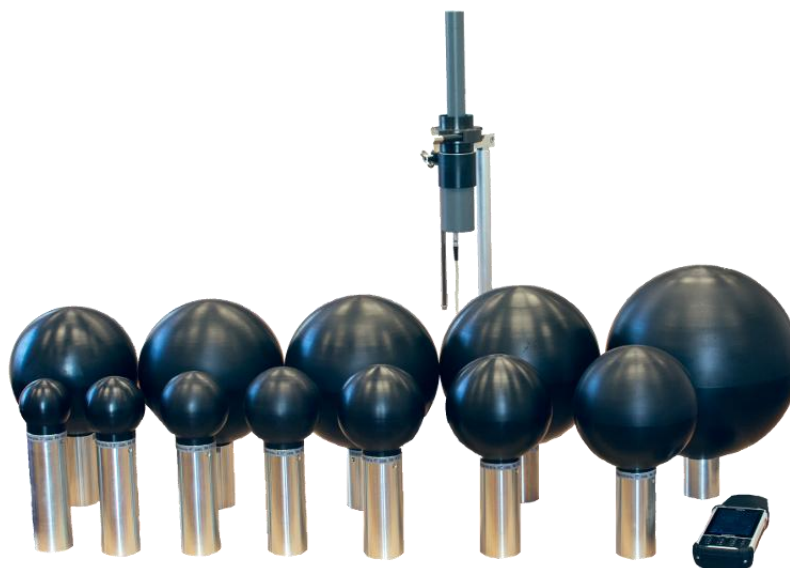
Рис. 27. Внешний вид спектрометра нейтронов с блоком детектирования и набором сфер замедлителей.
